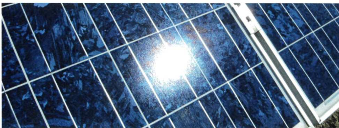
Bild 3.2.2: Diffuse Reflexion von direktem Sonnenlicht (Einstrahlung ca. 980 W/m²) auf einem PV Modul (Quelle: SolPEG)
